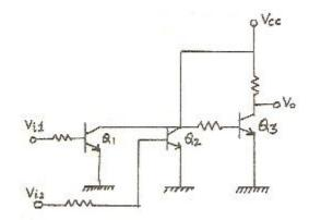
$\begin{array}{cccccc} L \ (0) & H(1) & L \ (0) & L \ (0) & 0 \\ H \ (1) & L(0) & L \ (0) & L \ (0) & 0 \\ H \ (1) & H(1) & L \ (0) & L \ (0) & 0 \\ & & Logic \ NOR \\ Q_3 \ is \ an \ inverter. \end{array}$
